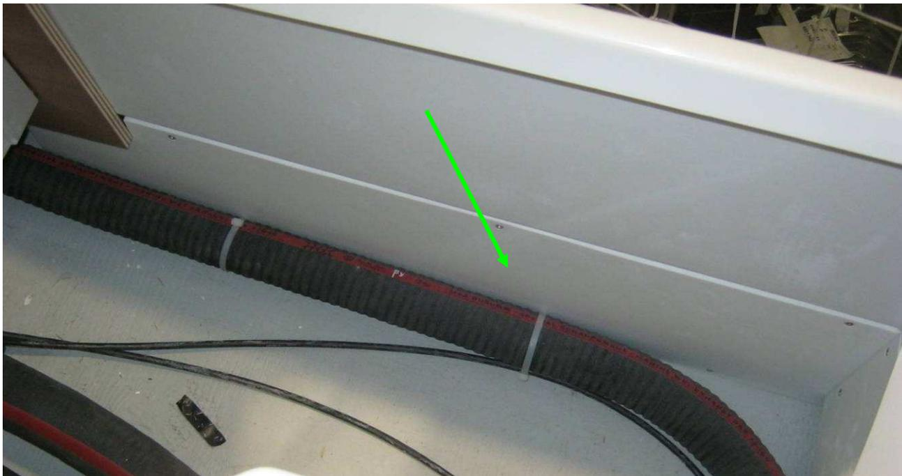
**Visser les protections du tuyau de chauffage**
